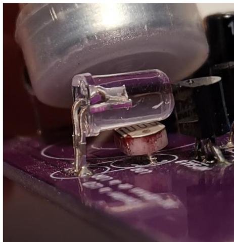
Une fois tous les composants montés sur la carte, vous pouvez souder les fils pour l'alimentation 9V, pour l'entrée et pour la sortie de l'effet. Laissez un peu de longueur pour pouvoir les bouger suffisamment dans le boîtier, quelques centimètres suffisent (5 cm environ).
